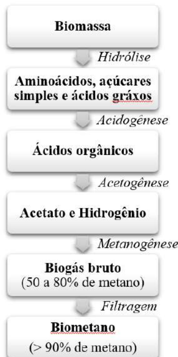
Figura 2 - Rota tecnológica de produção de biogás e biometano.
